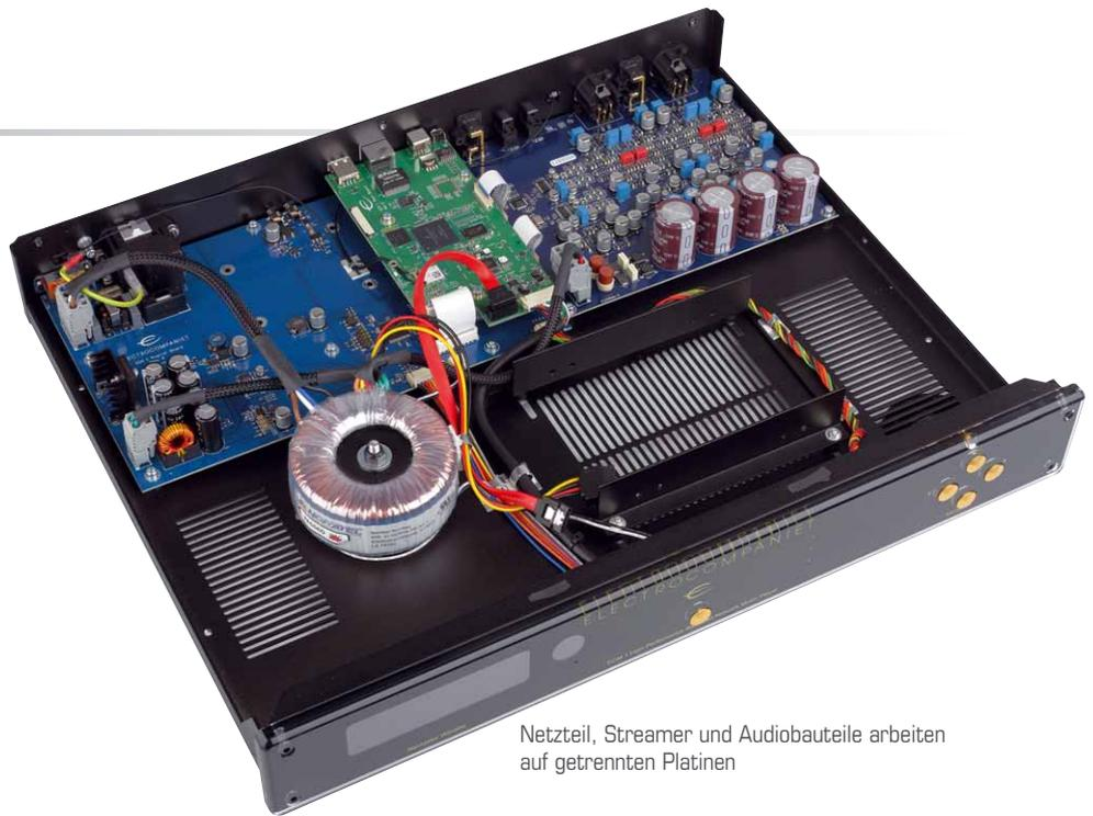
Netzteil, Streamer und Audiobauteile arbeiten auf getrennten Platinen
