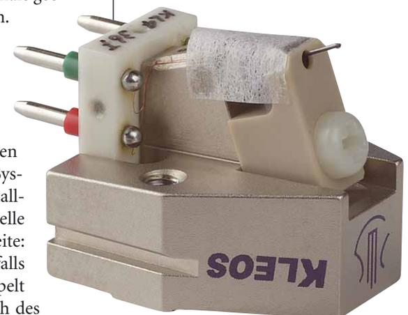
Der vordere Teil des Magnetkreises ist in einem Teflonlotz montiert
