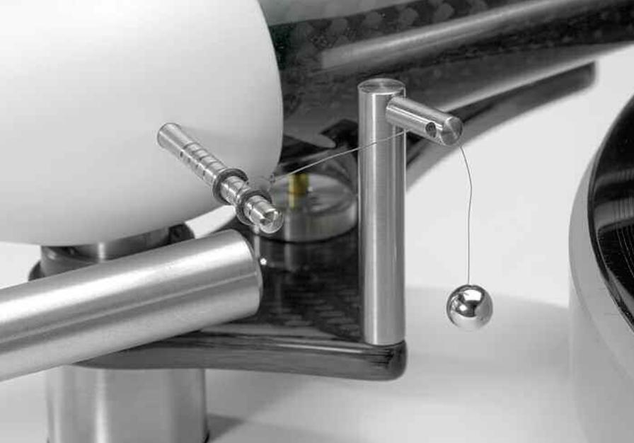
Clever: Damit der Faden für das Antiskating-Gewicht „am Platz“ bleibt, wird dieser um die dafür vorgesehenen Tonarmausleger-Einbungen geführt und mit Gummi-O-Ringen rechts und links davon am Wegdriften gehindert
